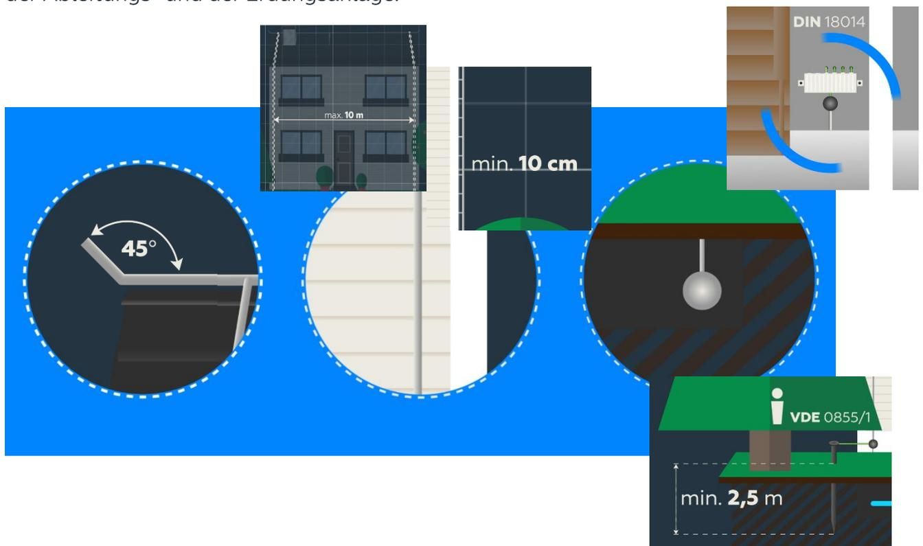
Die Fangeinrichtung sind Metallspitzen, die auf den höchsten Punkten des Gebäudes nach oben ragen und so den Blitzeinschlag anziehen. Sie verlaufen in der Regel über den Giebel und enden an den Giebelkanten mit um 45 Grad nach oben gebogenen Spitzen.
