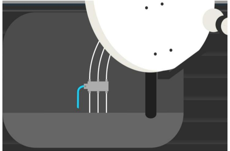
Nach jedem Verstärker oder Multischalter müssen erneut alle abgehenden Koaxkabel per Potentialausgleichsschiene mit dem Erdungsleiter verbunden werden oder direkt am Erdungsanschluss des Multischalters ausgeglichen werden.
