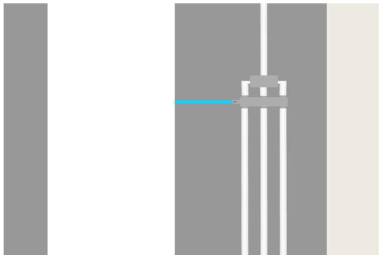
Da es besonders bei großen Gebäuden oft schwierig ist, mit nur einem Erdungsleiter vom Dach bis zur Potentialausgleichsschiene im Keller zu kommen, können die Erdungskabel alternativ auch über das metallene Stahlskelett des Gebäudes bis zum Boden gelegt werden.
