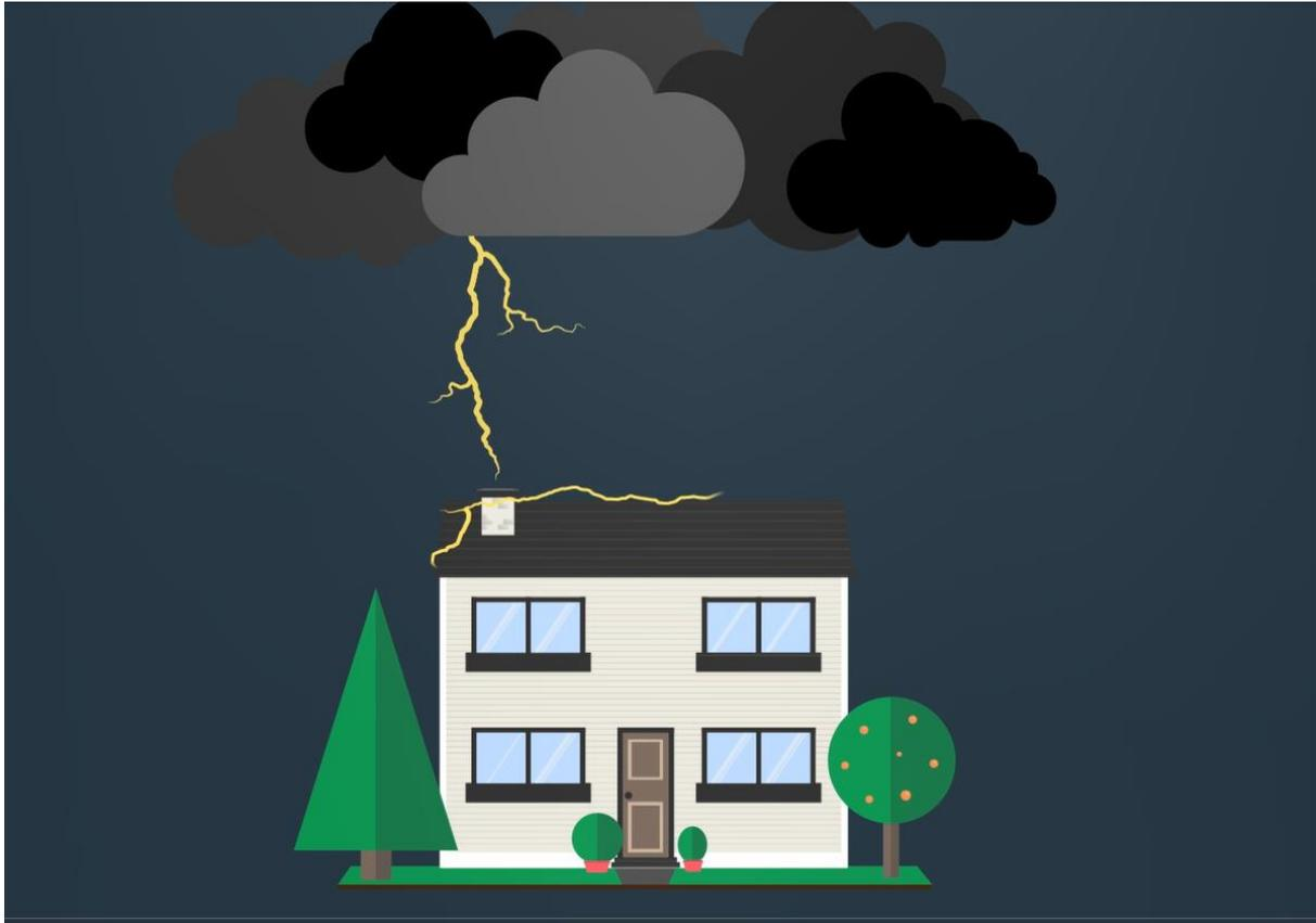
Wird ein Gebäude von einem Blitz getroffen, frisst sich dieser durch das gesamte Haus in die Erde. Die hohen Widerstände der Bausubstanz und die hohe Stromstärke des Blitzes können Feuer auslösen.
