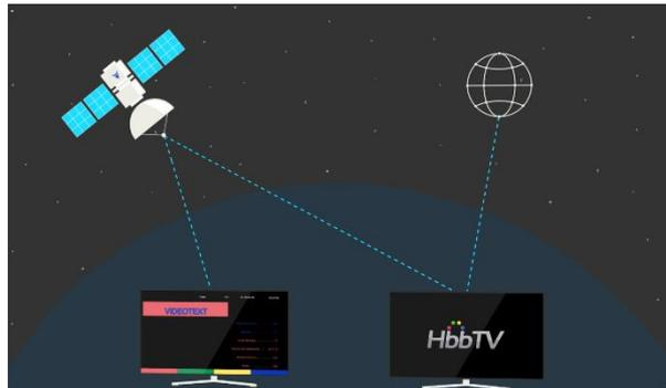
Digitale Datenströme werden immer in kleinen Datenpaketen zu den entsprechenden Decodern geschickt. Dabei ist egal, wie die Datenströme geschickt werden, ob über einen Träger moduliert, z.B. DVB-S- oder DVB-S2-Datenströme von einem Satelliten oder als TCP/IP-Datenströme über ein DSL-Netz.
