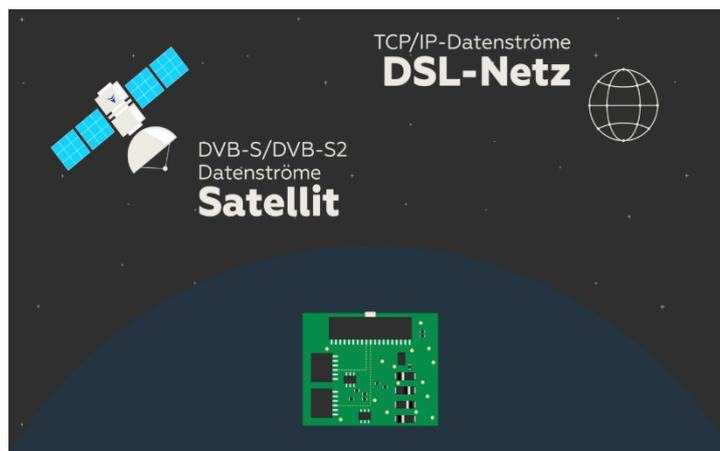
Die Übertragung per TCP/IP setzt für HDTV-Qualität zwar eine gewisse Mindestbandbreite der DSL Leitung voraus, macht aber im Gegensatz zu anderen Übertragungswegen dank einer bidirektionalen Ethernet-Schnittstelle einen Rückkanal möglich, d.h. die Möglichkeit für Antworten und Reaktionen des Kunden.
